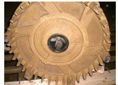
Auch die Unterseite des Tauchbelüfters zeigt erheblichen Eisenbesatz, der allerdings technisch ohne Relevanz ist (Foto: Tsurumi)
