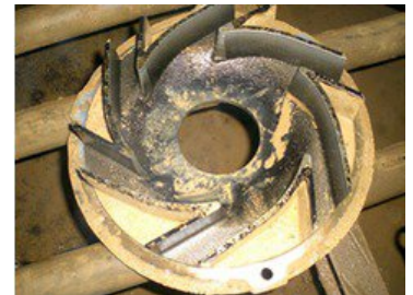
Laufwerk des Tsurumi-Tauchbelüfters: Keine Spur von Ablagerungen (Foto: Tsurumi)
