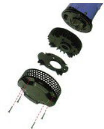
Ist die Pumpe in Modulbauweise konzipiert, sind zum Austausch zum Beispiel eines Laufrades nur wenige Schrauben zu lösen. Das können Anwender vor Ort selbst durchführen (Foto:Tsurumi)
