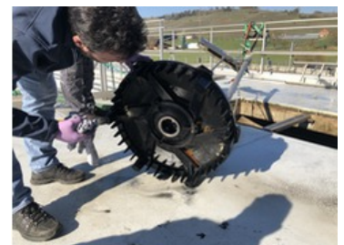
Nach Entfernen der Schleißplatte präsentiert sich der Belüfter im Bestzustand: Von Verstopfungen keine Spur, lediglich leichte Verschmutzungen sind sichtbar (Foto: Tsurumi)
