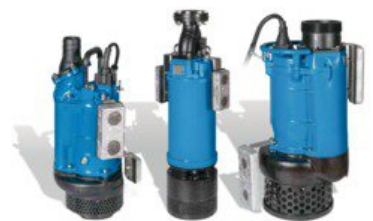
Tauchpumpen für Schmutzwasser: Nachgerüstete Anodenblöcke verhindern, dass der Pumpenkörper schnell Korrosion ansetzt (Foto: Tsurumi)
